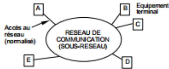
Réseau de communication
